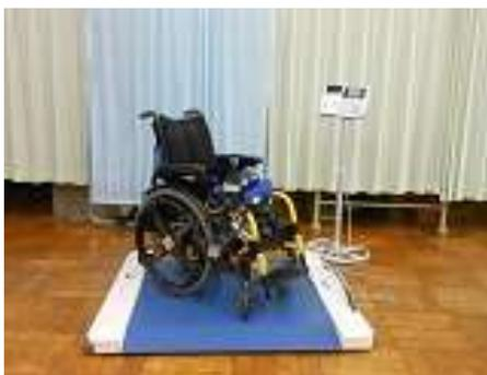
写真のように車いすごと体重計に乗ることができます。風袋引きができるので、児童生徒の体重のみが測れます。
